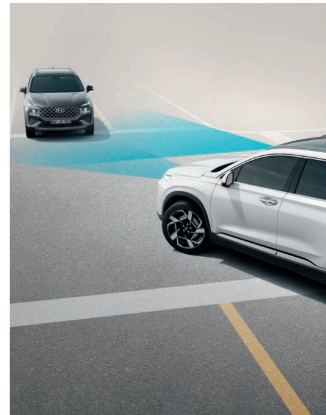
Systém autonómneho núdzového brzdenia (FCA) Asistenčný systém monitoruje premávku pred Santa Fe a keď hrozí riziko kolízie s vozidlom náhle brzdiacim vpredu alebo s chodcom či cyklistom, najprv vás upozorní a potom aj automaticky zabrzdí. Rovnako funguje aj pri odbočovaní vľavo na križovatke, ak sa blíži protiidúce vozidlo.
