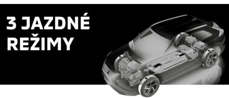
Mitsubishi Eclipse Cross PHEV 4x4 ponúka tri jazdné režimy plug-in hybridného pohonu, ktoré sa aktivujú automaticky v závislosti na aktuálnych jazdných podmienkach: čisto elektrický režim, sériovo hybridný režim a paralelný hybridný režim.
