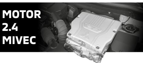
Nová benzínová jednotka s objemom 2,4 litra používa systém premenlivého časovania ventilov MIVEC a v závislosti od režimu jazdy hľadko prepína medzi Ottovým a Atkinsonovým spaľovacím cyklom, aby bola zabezpečená čo najvyššia efektivita motora.
