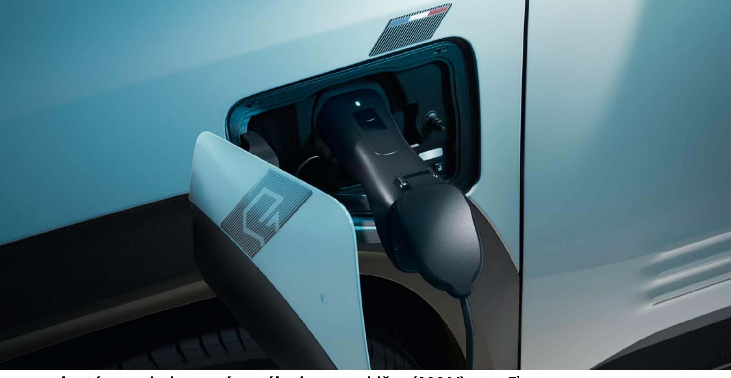
adaptér pre obojsmerné napájanie spotrebičov (220 V) – typ E 1
