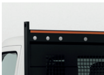
Ochrana kabíny s funkciou nosiča dlhých predmetov váhy max. 400 kg (otvory slúžiace na fixáciu nákladu).
