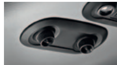
Individuálna klimatizácia: nad každým sedadlom
