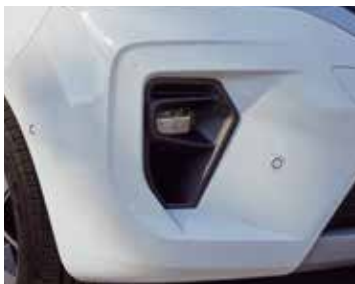
LED predné hmlové svetlá s technológiou prisvecovania do zákrut [1]
