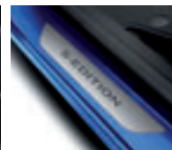
Vnútorné kryty prahov dverí
