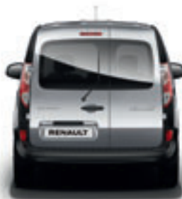
Zadné dvere otvárateľné do uhla 180°, presklené s vyhrievaným sklom a zadným stieračom
