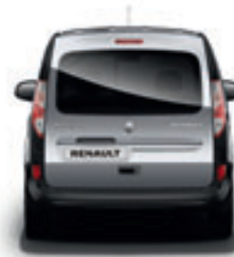
Zadné výklopné dvere, presklené, s vyhrievaným sklom a stieračom
